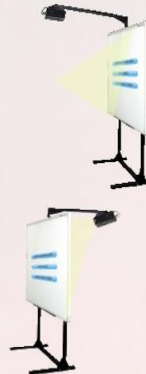
П. 2.5. При выборе ИД **прямой** проекции (проектор размещен перед ИД) рекомендуется использовать коротко- или ультракороткофокусный проектор, снижающий риск слепящего эффекта для пользователя.
